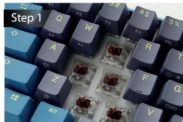
Usar o switch puller para remover os switches
